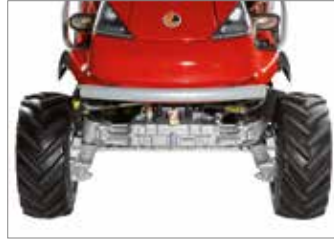
A gép nagyméretű, alacsony súlypontú futófelülete, ami maximális stabilitást biztosít egyenetlen talajon, folyópart és árok közelében.
