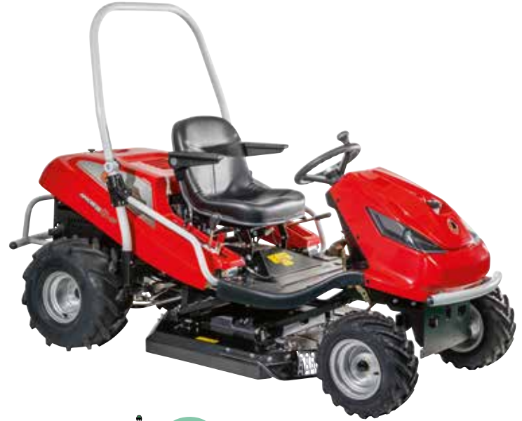
Szériában borulásvédő kerettel, első és hátsó lökhárítóval, oldalvédelemmel és biztonsági övekkel felszerelve a maximális védetség biztosítására a legösszetettebb helyzetben végzett műveletek során is.
