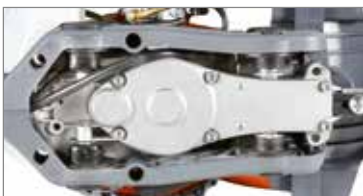
Rezgéscsillapító rendszer 4 rugóval, ami a gépkezelő kezének teljes elszigetelését biztosítja.
