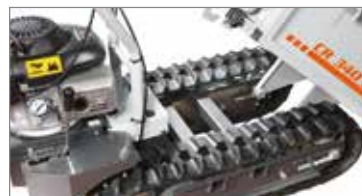
Masszív acélszerkezetes alváz. Az alacsony súlypont optimális stabilitást biztosít a munkavégzés során lejtős talajon is. A motor és az áttétel magas pozíciója kényelmessé teszi a karbantartást.
