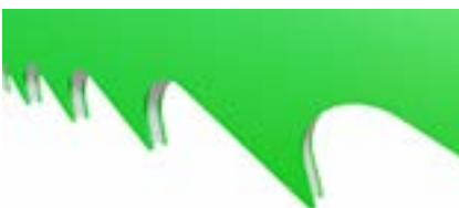
Többélű vágóél Szétdaraboltabb forgács
